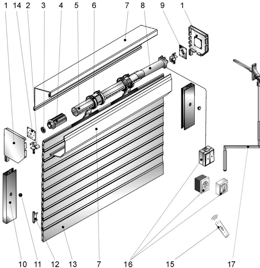
Рис. 2. Комплектация роллет с электроприводом,
