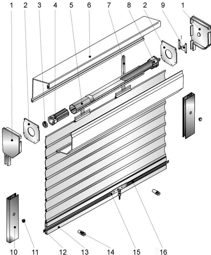
Рис. 6. Комплектация роллет со шнуровым или кордовым приводом:
